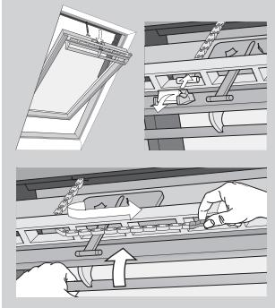
U slučaju nestanka struje ili ispraznjene baterije, vaš krovni prozor sa središnjim vješanjem krila se može ručno zatvoriti odvajanjem lanca na ventilacijskom preklopu prozora. Pogledajte kako se prozor zatvara ručno u kompletном uputstvu za daljinski upravljač na dodir. Molimo kontaktirajte firmu VELUX, pogledajte telefonsku listu ili [www.velux.com](http://www.velux.com).
