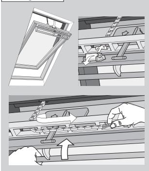
En cas de panne de courant ou batterie faible, votre fenêtre à rotation peut être fermée manuellement en libérant la chaîne sur le clapet de ventilation de la fenêtre.
