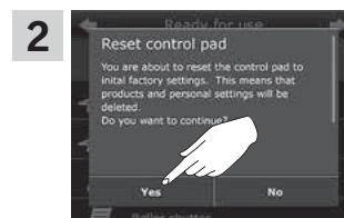
Tik op "Ja" om te bevestigen dat u de bedieningstablet wilt resetten. De bedieningstablet is nu gereset. Om de bedieningstablet opnieuw in gebruik te nemen, zie de sectie *De eerste configuratie*.
