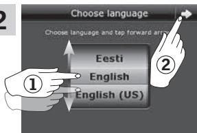
Kies een taal door met het wiel door een vinger over het scherm in de richting van de pijlen te slepen ①.
