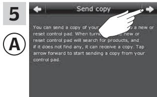
Tik op  $\Rightarrow$  in bedieningstablet **(A)** gevolgd door  $\Rightarrow$  in bedienings-tablet **(B)**.
