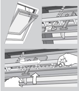
In caso di interruzione di corrente o batteria scarica, puoi chiudere la tua finestra per tetti con apertura a bilico manualmente staccando la catena dall'aletta di ventilazione.
