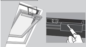
Als uw bedieningstablet kwijt bent, dan kan uw dakraam toch worden gesloten door op een testknop op het dakraam te drukken.
