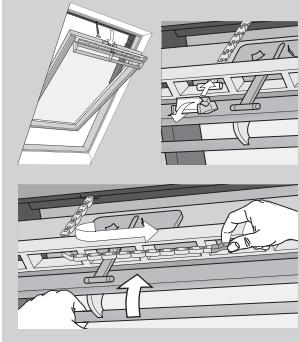
In het geval van stroomuitval of lege batterij kan het tuimelvenster met de hand worden gesloten door het ontkoppelen van de ketting van de dakraamopener.
