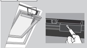
Si votre commande tactile a été égarée, votre fenêtre peut être fermée en appuyant sur le bouton, situé sur la fenêtre.
