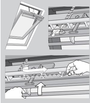
En el caso de problema de suministro de corriente o descarga de batería, su ventana giratoria puede cerrarse manualmente si desengancha la cadena del aireador de la ventana.
