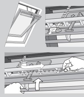
Im Falle eines Stromausfalls oder eines entladenen Akkus, können Sie Ihr Schwingfenster durch Aushängen der Kette an der Lüftungsklappe des Fensters manuell schließen.
