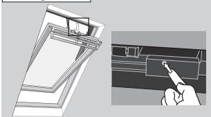
Pokud jste ovládací panel ztratili, lze okno zavřít stiskem tlačítka přímo na něm.
