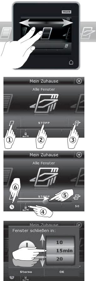
Sie bedienen alle Produkte durch Tippen der Symbole/Tasten oder durch Ziehen des Schiebereglers oder Tippen des Balkens auf dem Display.
