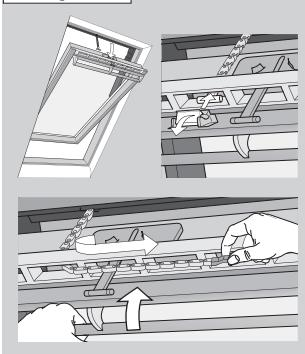
V případě výpadku el. energie nebo vybití baterie lze kyvné okno zavřít ručně odpojením řetězu na ventilační klapce okna.
