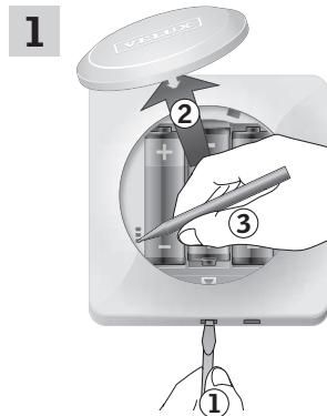
Uklonite poklopac odjeljka za baterije tako što ćete odvijačem pritisnuti gumb za otpuštanje, kao što je prikazano na slici ①, ②.
