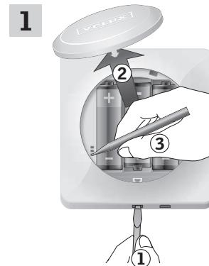
Rimuovi il coperchio delle batterie premendo il tasto con un cacciavite, come mostrato nell'illustrazione **①, ②**.
