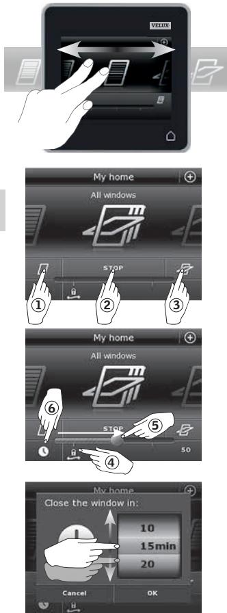
U bedient alle producten door te tikken op de pictogrammen/knopen of door de schuifregelaar te slepen of te tikken op de balk in het scherm.
