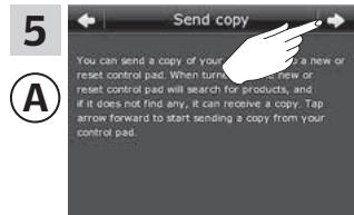
Na ovládacím panelu **A** klepněte na tlačítko  $\Rightarrow$  a poté klepněte na tlačítko  $\Rightarrow$  na ovládacím panelu **B**. Pokud je na displeji zobrazena možnost "Žádné výrobky nenašly", klepněte na možnost "Hledat znovu" a zkuste to znova.
